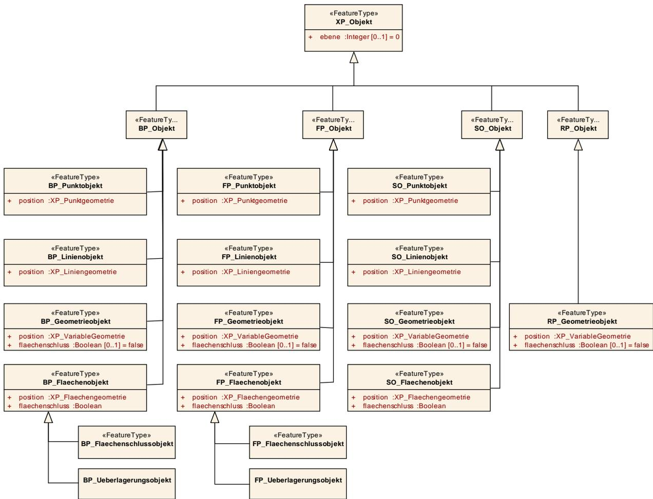
Abbildung 1: Struktur der Basisklassen für XPlanung Fachobjekte
